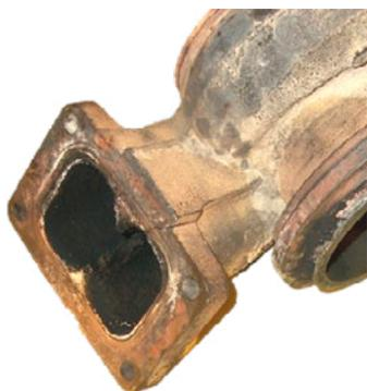
Erosão da carcaça da turbina devido ao calor excessivo causado por aplicação incorreta
