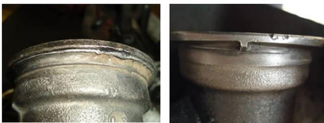
Danos ao bocal do compressor devido a instalação incorreta
