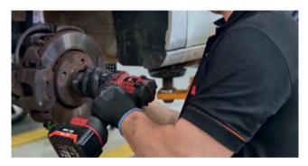
3 • Continue retirando o parafuso de trava do pivô da bandeja de suspensão e retire o pivô da bandeja.
