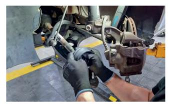
12 • Coloque a homocinética na ponta do eixo e use o saca-homocinética para pressioná-la e fixá-la adequadamente. É importante evitar o uso de martelos e marretas, pois podem danificar a peça.
