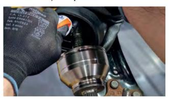
14 • Instale as abraçadeiras fornecidas no kit da homocinética nas duas extremidades da coifa de proteção.
