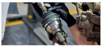
15 •> Encaixe o eixo estriado da homocinética no cubo de roda.
