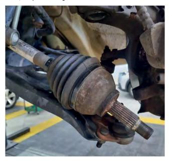
Fizemos a substituição do item com Volda, especialista no sistema. Na hora da troca, esteja atento ao uso de EPIs e ferramentas adequadas para remover e instalar a junta, evitando que a peça seja danificada.
