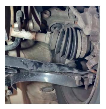
No diagnóstico, um dos itens mais cruciais é a coifa, que se estiver danificada deve ser substituída para evitar a contaminação da junta por sujeira e poeira. A junta homocinética também deve ser lubrificada com graxa adequada, já que se perder lubrificação devido a danos na coifa, será necessário reabastecer com graxa nova.
