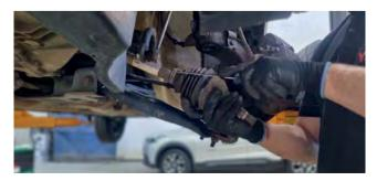
**6** • Em seguida, desencaixe a homocinética do eixo utilizando o equipamento apropriado, o saca-homocinética.
