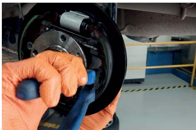
**16** ➤ Em seguida, fazer a lubrificação nos três pontos principais, onde a sapata encosta.
