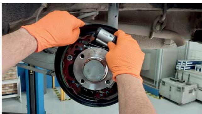
**Obs.:** Antes de montar a peça nova, é imprescindível fazer a verificação da aplicação correta da peça. Lembrando que o cilindro novo vem sem o parafuso de fixação, então tem que usar o que foi removido.
