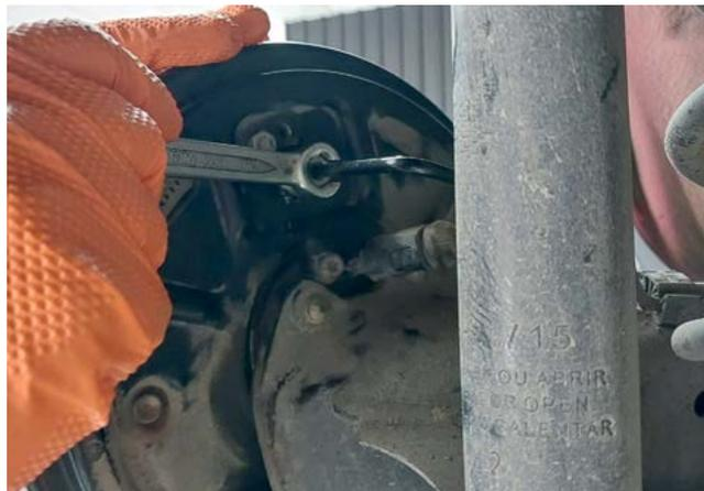
12 ➤ Em seguida, com uma chave 10, solte o parafuso de fixação da cilindro de roda. Não precisa de torque na montagem
