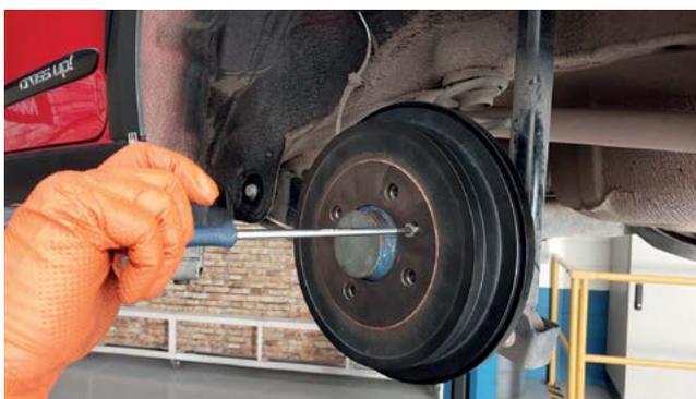
**Obs.:** Esse processo de remover o excesso de sujeira é essencial para manter totalmente limpa a superfície do cubo e do tambor, pois se tiver alguma impureza ele perde o centro dele e aí ele pode vibrar.
