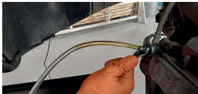
4 ➤ E aí, o scanner entra para garantir o processo de sangria. Para finalizar, verifique o nível do fluido no reservatório. Se necessário, completar. Se tiver excessivo, remover um pouco para dar o nível correto e fechar o reservatório.
