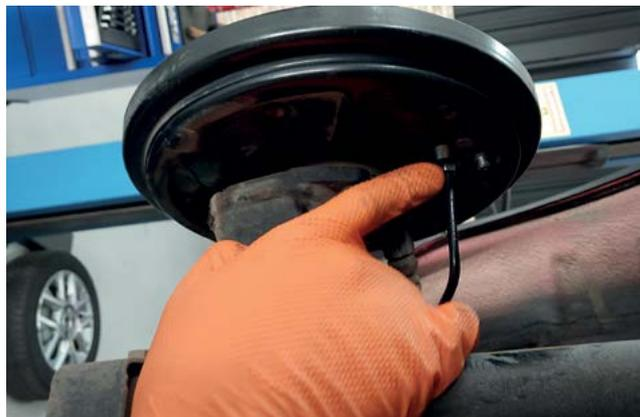
11 ➤ Agora sim, vamos soltar a tubulação do fluido de freio e a fixação do cilindro em relação ao espelho, começando pelo parafuso da sangria.
