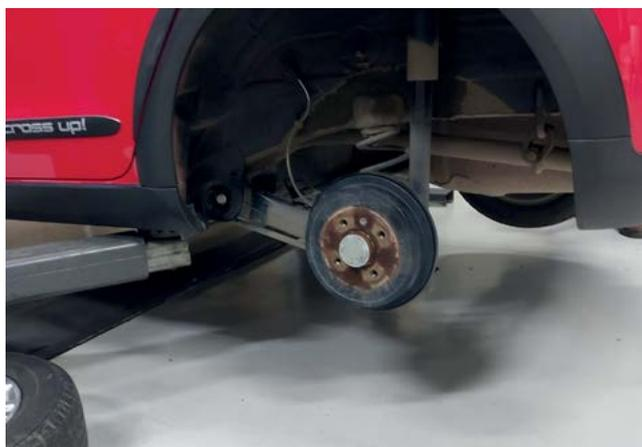
“Por isso, na sangria do sistema que a gente vai fazer depois da troca do cilindro de roda, com a substituição do fluido de freio, é indicada a utilização de um scanner para que seja eliminado todo o ar possível, deixando o sistema sem bolhas de ar”, explica Eduardo.
