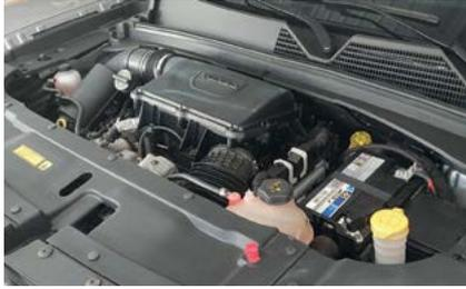
A sigla é famosa: R/T e significa "Road/Track" ou seja, Estrada/Pista, o que na realidade quer dizer que a picape é boa para qualquer condição de solo. O motor é tão famoso quando a sigla: Hurricane 4, um conjunto de 2 litros a gasolina, construído em alumínio, com injeção direta e duplo comando variável de válvulas.
