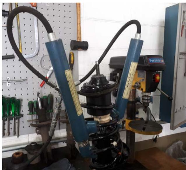
Existem no mercado kits de ferramentas especiais para substituição de amortecedores que atendem grande parte das peças existentes no mercado e são necessários para processos como, por exemplo, travar a haste do amortecedor no momento do torque final.
